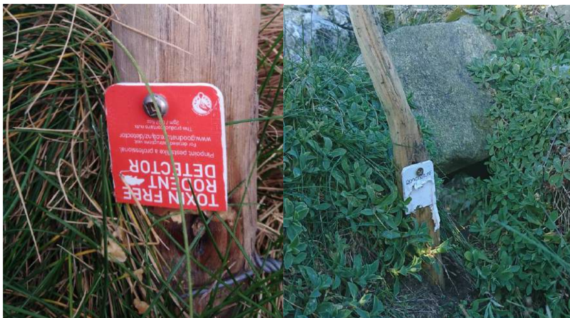
Fig. 10 : Détecteur témoin mis en place sur l'île Vierge (à gauche). Détecteur grignoté par le rat (à droite, Cl. : L. Dutouquet).
